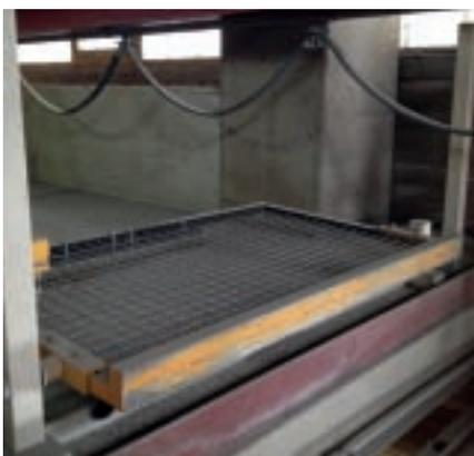
Das Gitter ist drehbar gelagert und mit einem pneumatisch betriebenen Zylinder ausgerüstet, der das Gitter im Normalbetrieb in einer horizontalen Lage hält, damit die Kübelbahnen darüber hinwegfahren können. Betritt ein Mitarbeiter die Bühne über die Zugangstür, wird über die integrierte Steuerung der Pneumatikzylinder aktiviert. Dieser fährt das Gitter in die aufrechte Position
