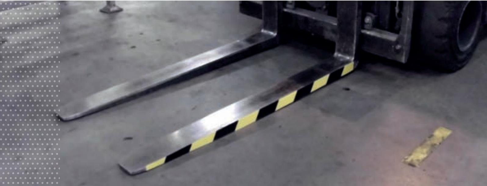
In Produktions- und Lagerbereichen werden häufig Stapler eingesetzt und man beobachtet immer wieder, dass diese Fahrzeuge abgestellt werden und ihre Zinken dabei in Verkehrs- und Arbeitsbereiche hineinragen. Die Zinken bilden in vielen Fällen Stolperstellen und sind damit eine Gefährdung für die hier tätigen Mitarbeiter. Begünstigt wird die Gefährdung häufig noch durch ungünstige Lichtverhältnisse, sodass die Gabelzinken sich manchmal kaum vom Untergrund abheben.
