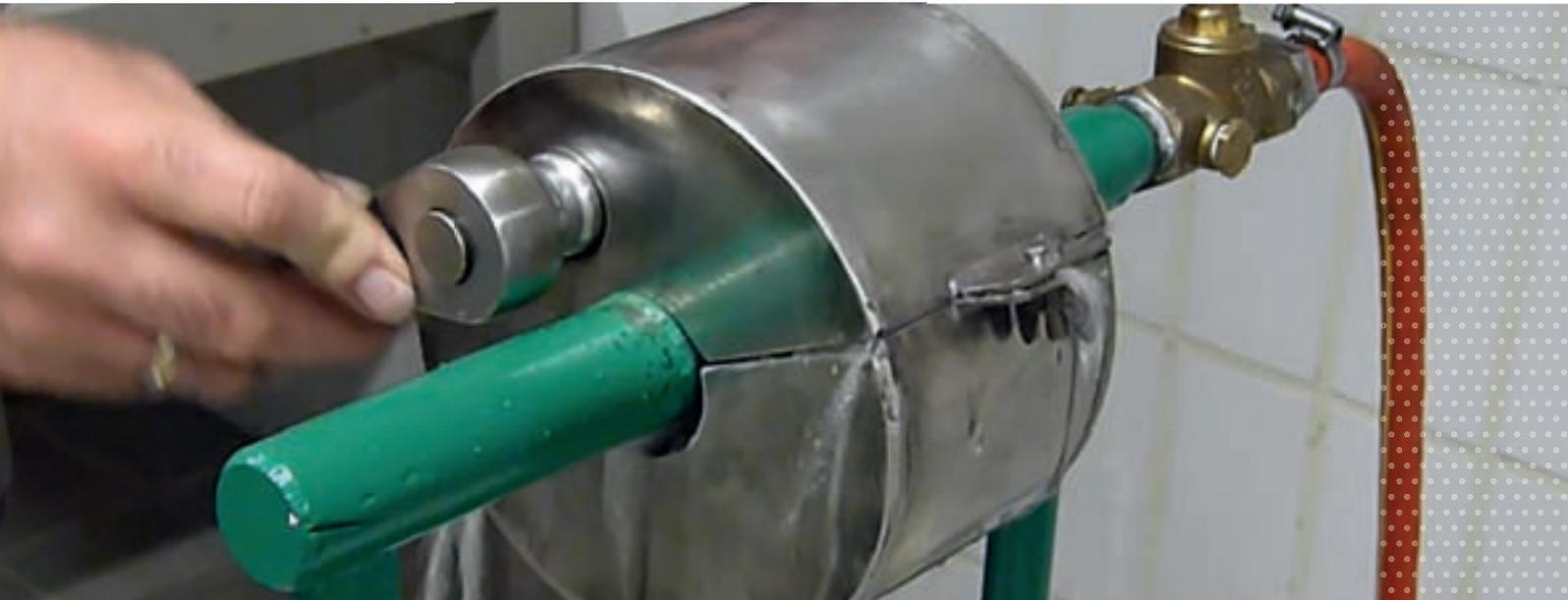
Beim Öffnen von Rohrleitungen in der chemischen Industrie besteht die Gefahr, dass beteiligte Personen durch einen unter Druck stehenden Stoffaustritt gefährdet werden. Persönliche Schutzausrüstungen (PSA) können die Gefahrstoffe abhalten, doch sind diese Schutzausrüstungen nach einem Zwischenfall oft stark kontaminiert. Bei der AlzChem AG, Trostberg, wurde deshalb ein mobiler Spritzschutz zum Öffnen von Rohrleitungsflanschen entwickelt.
