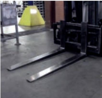
In der Vergangenheit mehrten sich bei der Freudenberg ST GmbH & Co. KG, Weinheim, die Stolper- und Sturzunfälle aufgrund zu spät oder nicht erkannter Staplerzinken. Dies führte zu der Frage, wie die Zinken von Staplern oder anderen Flurförderfahrzeugen besser sichtbar gemacht werden können. Bei den Überlegungen im Vordergrund stand eine einfache und praktikable Lösung.
