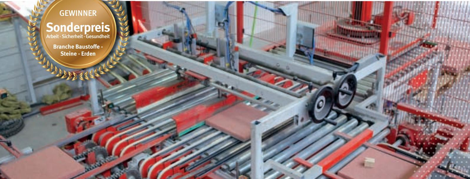
Im Unternehmen BraunBeton GmbH wurde im Rahmen eines Anlagenneubaus zur Herstellung von Betonsteinen eine automatische Aussortierung von beschädigten und optisch mangelhaften Betonsteinen entwickelt und installiert. Körperlich belastende und unergonomische Sortierarbeiten sollten entfallen. Schnell wurde deutlich, dass es auf dem Markt kein Gerät gab, das zuverlässig erkennen konnte, wann ein Betonstein defekt ist oder einen optischen Mangel hat.
