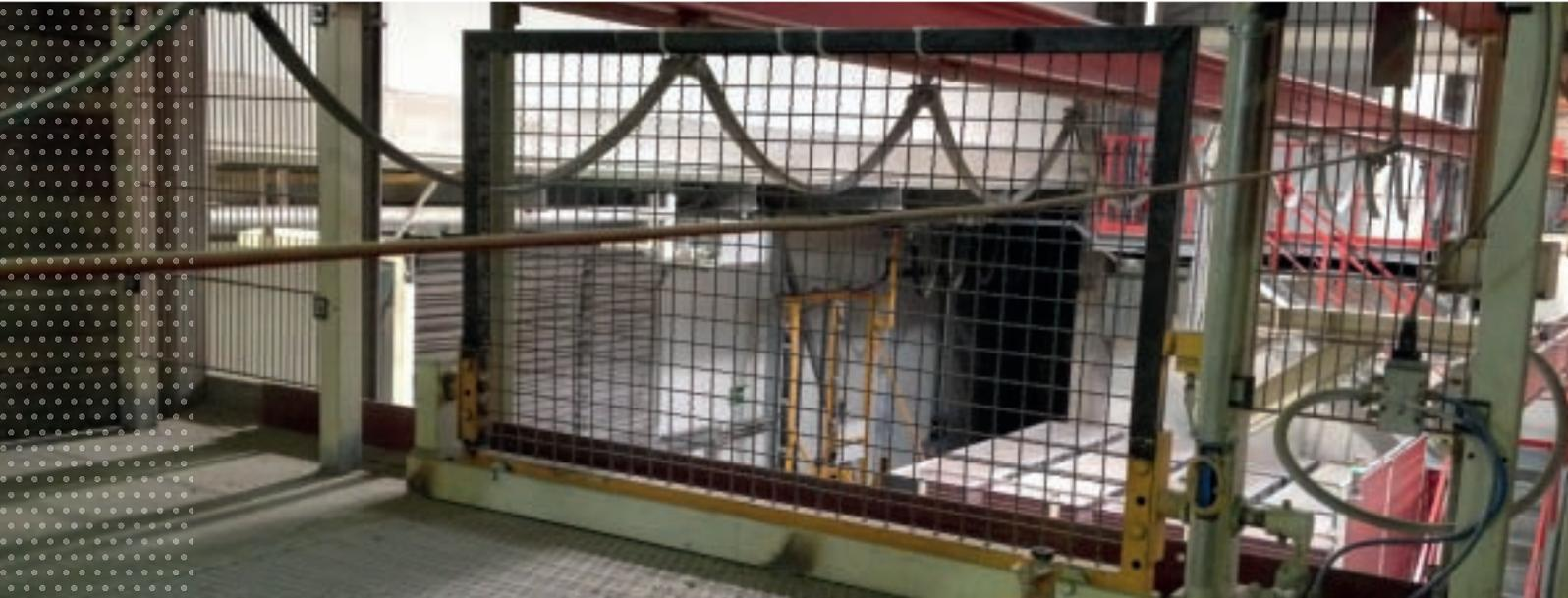
Die Rinn Beton- u. Naturstein GmbH & Co. KG, Heuchelheim, stellt Betonsteine her. Die Versorgung des Steinfertigers mit Beton wird über zwei Kübelbahnen gewährleistet, die jeweils einen bestimmten Beton transportieren. Die Kübelwagen fahren im Automatikbetrieb unter die Mischer und werden aus diesen mit Beton befüllt. In regelmäßigen Abständen müssen die Kübel gereinigt, gewartet oder repariert werden. Hier besteht Absturzgefahr.
