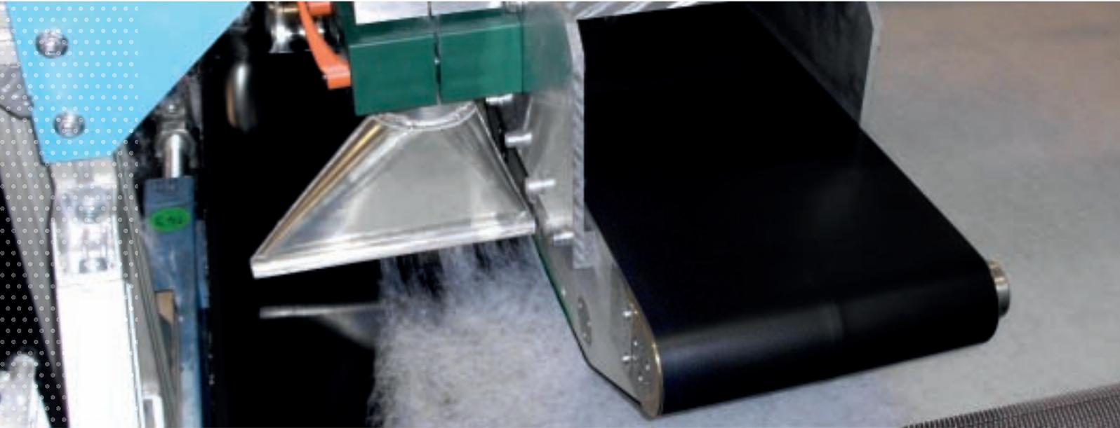
Auf einer Anlage zur Vliesstoffherstellung wurde der Rand bisher mit Rollenmessern beschnitten. Diese Rollenmesser bildeten eine permanente Gefahr, da der Messerbereich weder bei der Produktion noch beim Messerwechsel zufriedenstellend abzusichern ist. Bei der Freudenberg Interlining SE & Co. KG, Weinheim, suchte man nach einer Lösung, diese Gefährdung zu beseitigen.
