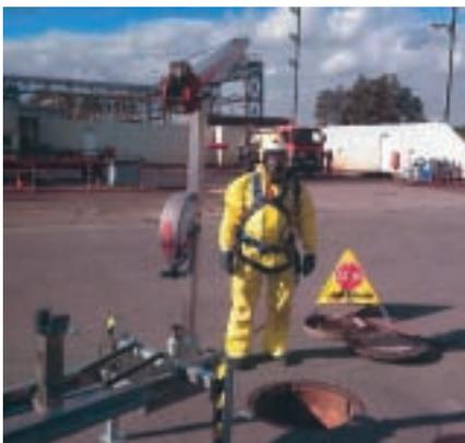
Entwickelt wurde der Anhänger in der ExxonMobil Production Deutschland GmbH, Großenkneten. Auf dem Fahrzeug sind ein fünfteiliger Kragarm mit Abseileinrichtung und ein Druckluftschlauchgerät installiert. Der Anhänger wird vor dem jeweiligen Einstieg positioniert. Der Kragarm wird an einem Schienensystem aus dem Anhänger herausgezogen und mit Stützen über der Bodenöffnung positioniert.
