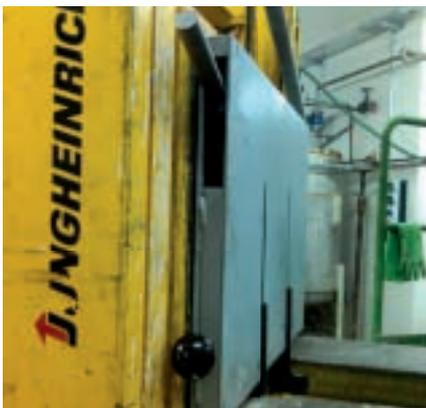
Das Bauteil ist 3 cm dick, 63 cm breit und 50 cm hoch. Im vorliegenden Fall damit exakt an die Bauform des Hochhubwagens angepasst. Es wird direkt am Hubmast angebracht. Durch einen Hebel werden zwei Greifer, die sich zwischen den Gabeln befinden, nach oben bewegt und durch eine Arretierung gehalten.
