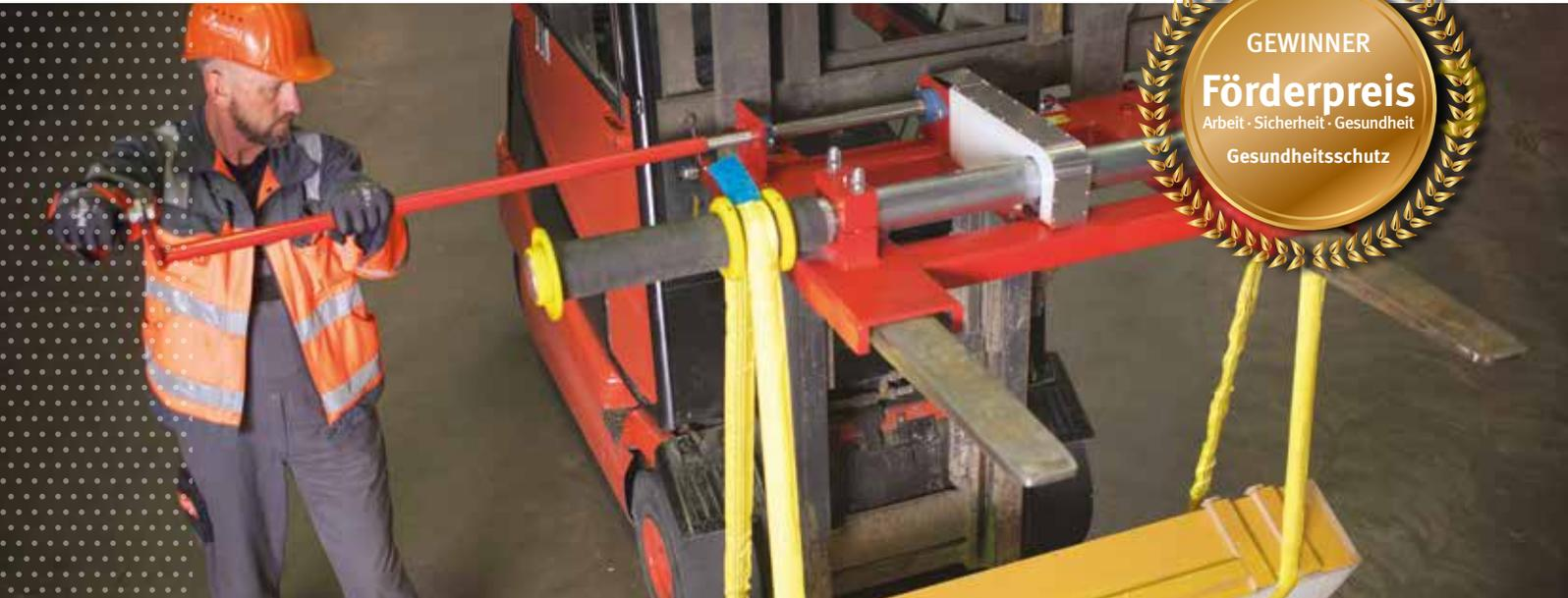
Betonelemente in Sonderformen müssen nach ihrer Aushärtung gewendet werden. Diese Tätigkeit ist ergonomisch häufig ungünstig und birgt neben der körperlichen Belastung eine Unfallgefahr. Ein Hersteller von Betonprodukten hat eine sicher bedienbare Drehvorrichtung entwickelt, die an den Gabelstapler angebaut wird und es mit einfachen mechanischen Mitteln ermöglicht, Betonteile verschiedener Abmessungen und Gewichte ergonomisch günstig und sicher zu bewegen.
