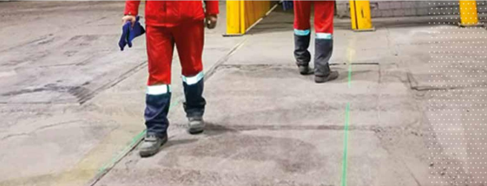
Aufgrund der betrieblichen Gegebenheiten bei Real Alloy in Grevenbroich war eine feste Abtrennung von Fuß- und Fahrwegen in manchen Bereichen nicht realisierbar. Bei staubigen und anhaftenden Einsatzmaterialien waren die gängigen Lösungen wie farbige Markierungen der Böden durch Farbe, Bodennägel oder Markierungsbänder wirkungslos. Diese wären nach wenigen Tagen unsichtbar. Um dennoch die Wegesicherheit in den betreffenden Bereichen zu erhöhen, wurde nach einer neuen Lösung gesucht.
