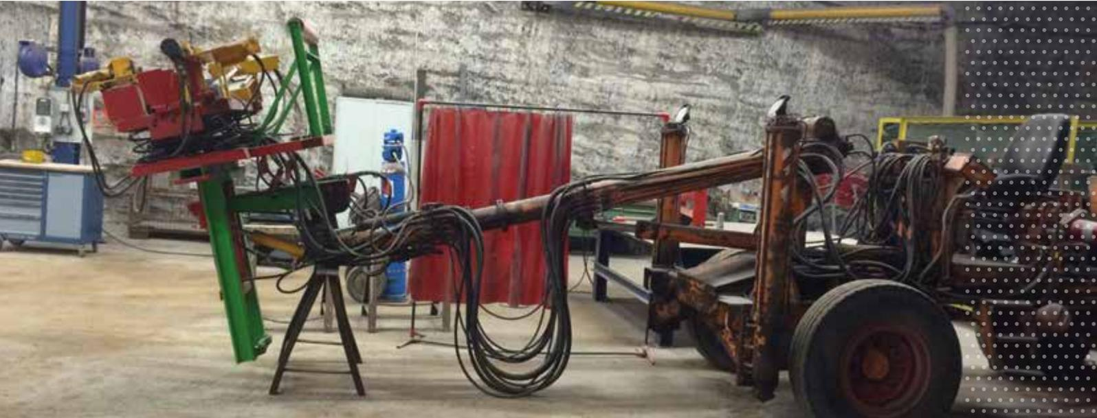
In der Südwestdeutsche Salzwerke AG wurde ein Reinigungsgerät entwickelt, das auf einen Bohrwagen montiert Anbackungen an Untergurtrollen entfernt. Damit entfallen manuelle Arbeiten, die bislang aus einem Arbeitskorb heraus an der Firste durchgeführt werden mussten und die neben einer hohen Belastung für das Skelett und die Muskulatur erhöhte Unfallgefahr bedeuteten.
