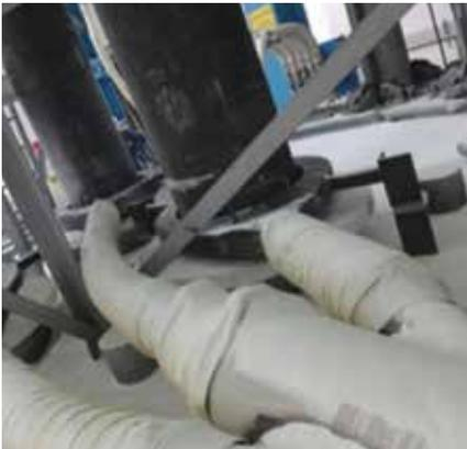
Um den Staubaustritt zu reduzieren, wurde das vorhandene Ofenentstaubungssystem angepasst. Es wurden Entstaubungsringe um die Elektroden installiert, welche mit dem existierenden Entstaubungssystem verbunden sind. Somit wird das aufsteigende Feinmaterial noch gezielter aufgesaugt und in einem geschlossenen Kreislauf in den Ofen zurückgeführt.
