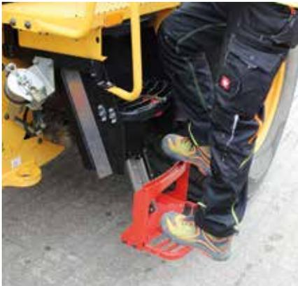
Die Griener Fahrzeugtechnik aus Pfullendorf-Otterswang liefert Komponenten für Nutzfahrzeuge aus Landwirtschaft, Forst und Transport. Für den sicheren Abstieg und ergonomischen Aufstieg an Geräten wie Erdbaumaschinen hat das Unternehmen den „Softstep“ im Programm.
