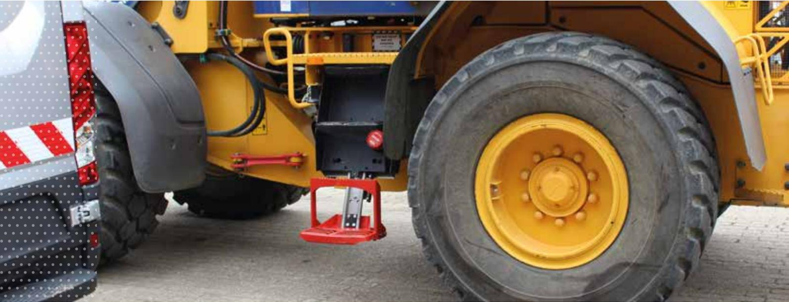
Ergonomisch rauf und sicher runter: Der GRIFA Softstep ist eine Auf- und Abstieghilfe für Fahrzeuge wie zum Beispiel Erdbaumaschinen. Die letzte Stufe beim Ausstieg senkt sich beim Betreten ab und verhindert so, dass ein Absprung die Gelenke belastet und Verletzungen provoziert. Da sich eine Einstiegshöhe von 30 cm bei einer Bodenfreiheit von 70 cm im Betrieb ermöglichen lässt, ist der Aufstieg entschieden ergonomischer möglich als bei starren Systemen in 70 cm Höhe.
