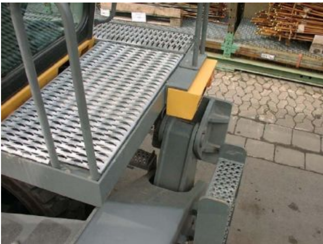
Laufroste und Aufstieg
