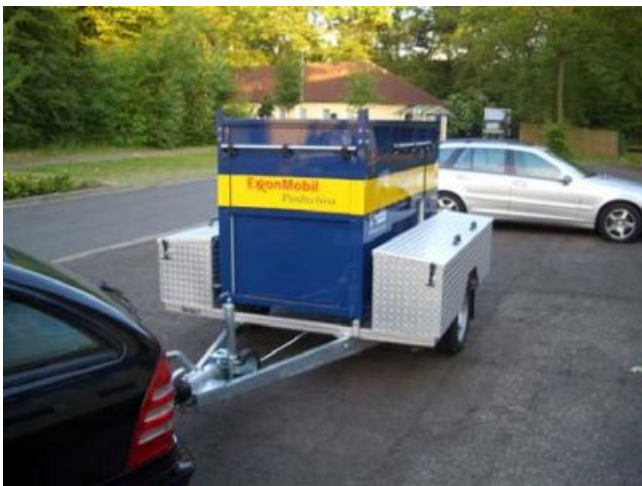
Container auf PKW_Anhänger Fahrgestell als Wechsellader montiert
