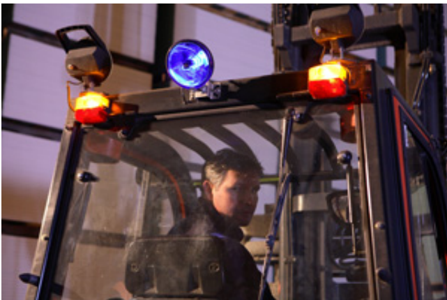
Der Blaulicht-Dachscheinwerfer am Dach des Gabelstaplers
