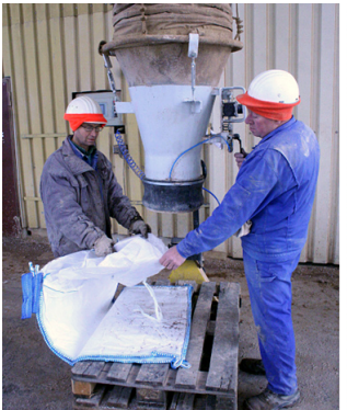
Big Bag Installation / Big Bag wird über Druckluftmanschette geschoben.
