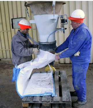
Big Bag Installation / Big Bag wird über Druckluftmanschette geschoben.
