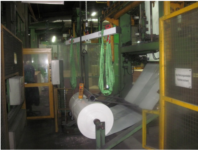
Kran zum Folienwechseln an der Verpackungsline
