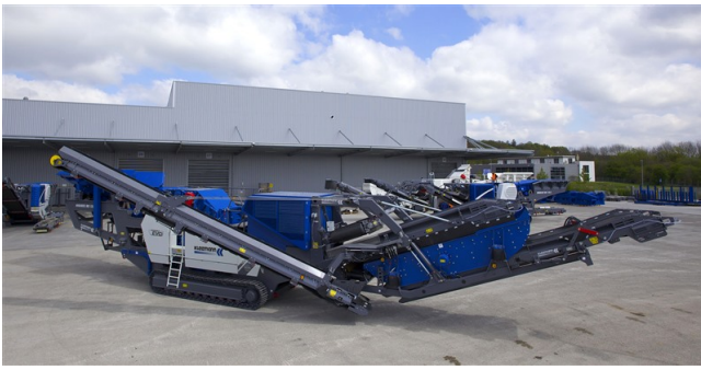
Mobiler Prallbrecher Mobirex EVO2 von Kleemann
