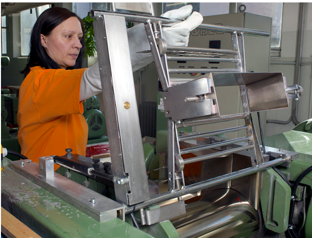
Reinigungsarbeiten bei geöffneter Schutzeinrichtung
