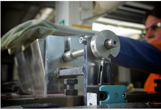
Schutzeinrichtung stoppt gefährbringende Bewegung
