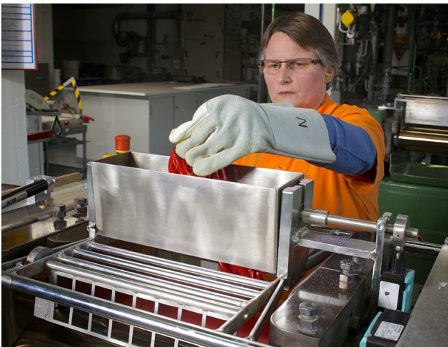
Sichere Materialzugabe am umgebauten Walzwerk
